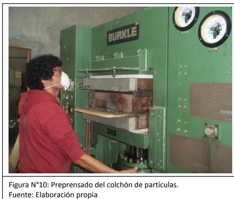
Figura N°10: Preensado del colchón de partículas.
