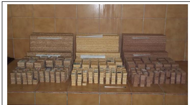
Figura N°13: Probetas para los ensayos físicos y mecánicos. Fuente: Elaboración propia.
